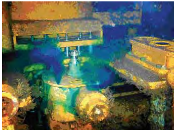
شکل ۱: نشت سیستم کنترلی- رنگ فلورسنت به وضوح در نشت سیال کنترلی مشاهده می شود
