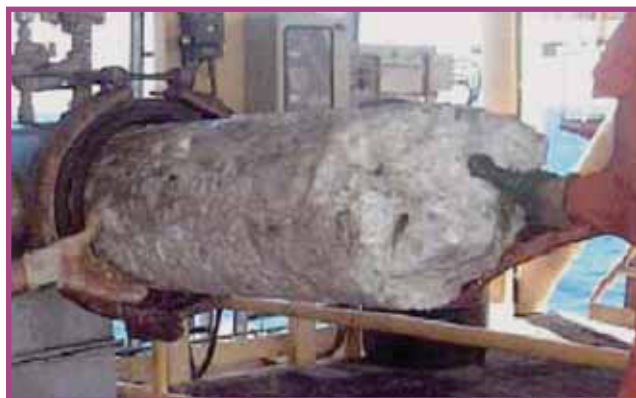
شکل ۱- نشان می‌دهد که کارگران مشغول خارج ساختن توده‌ی غظیمی از داخل یک لوله انتقال گاز می‌باشند. توده هیدرات جامد یخ‌مانندی است که باعث انسداد لوله‌ها و تجهیزات انتقال گاز طبیعی می‌گردد. هنگامی که شرایط تشکیل هیدرات در محیط PT فراهم شده باشد، امکان وقوع این مشکلات افزایش می‌یابد. این پدیده بخصوص در لوله‌های حفاری اعماق دریا و نواحی سردسیر بیشتر مشاهده می‌گردد [مقاله، R. Sorheim].
