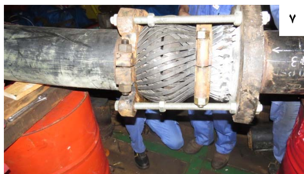
شکل ۱۱: مراحل مختلف نصب End Fitting بر روی لوله ارتجاعي
