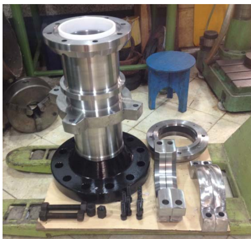
شکل ۳: End Fitting و Clampsهای مربوط به آن
