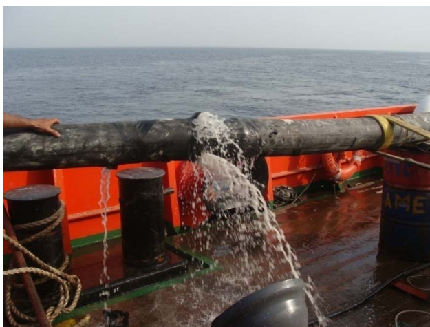
شکل ۲: لنگر کشتی تدارکاتی و خط لوله پس از برخورد لنگر
