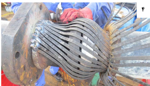
شکل ۱۱: مراحل مختلف نصب End Fitting بر روی لوله ارتجاعی (ادامه دارد)
